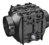
Für Fahrzeuge mit Verbrennungsmotor ist der Gebläsewärmetauscher HV1 eine ideale Lösung. Er besteht aus einem 12-V-Gebläse und einem Wasserwärmetauscher und kann so in den Kühlmittelkreislauf integriert werden. So kann der Innenraum während der Fahrt erwärmt werden. Im Stand heizt der HV1 GD autark in Verbindung mit einer Hydronic Standheizung.
